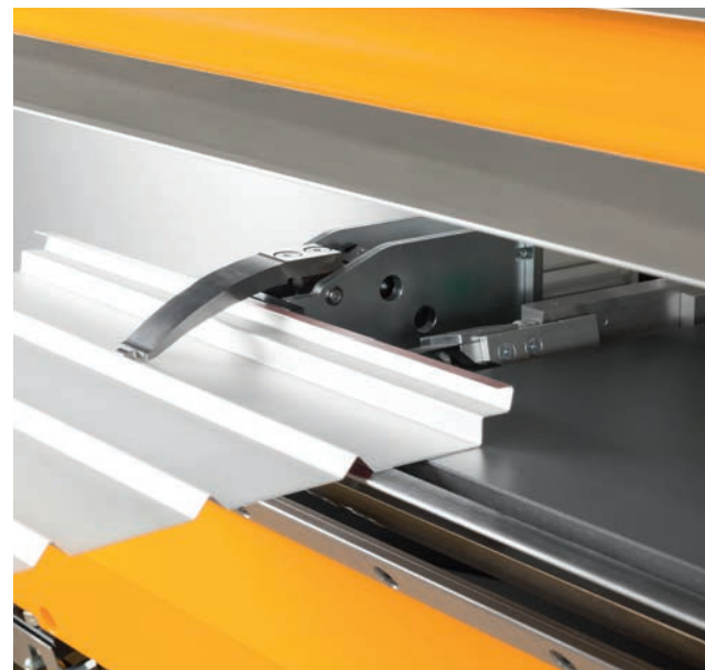
Das Pünktchen auf dem «i» leistet das vollautomatische Blech-Greifersystem. Es ermöglicht einen Arbeitsbereich von 14–1250 mm und kann dank Anschlagfinger auch noch Masse von nur 5 mm parallel anschlagen.
