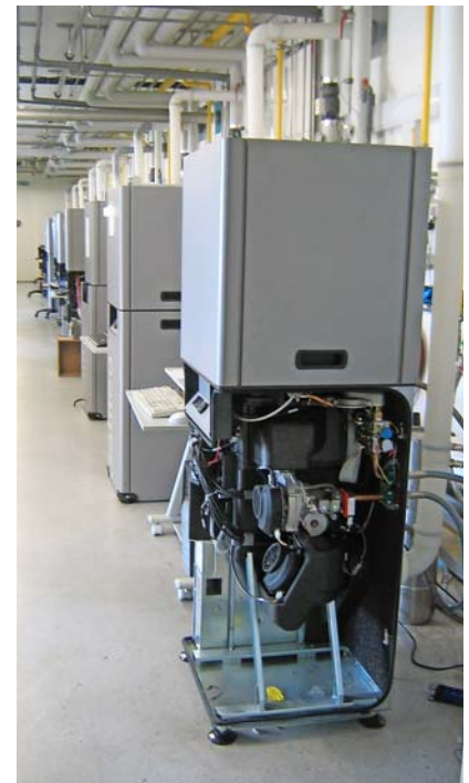
Im Labor in Oberwinterthur testet Hexis seine Brennstoffzellen-Heizgeräte über mehrere Jahre, um die Langlebigkeit der darin verbauten Brennstoffzellen zu untersuchen.
