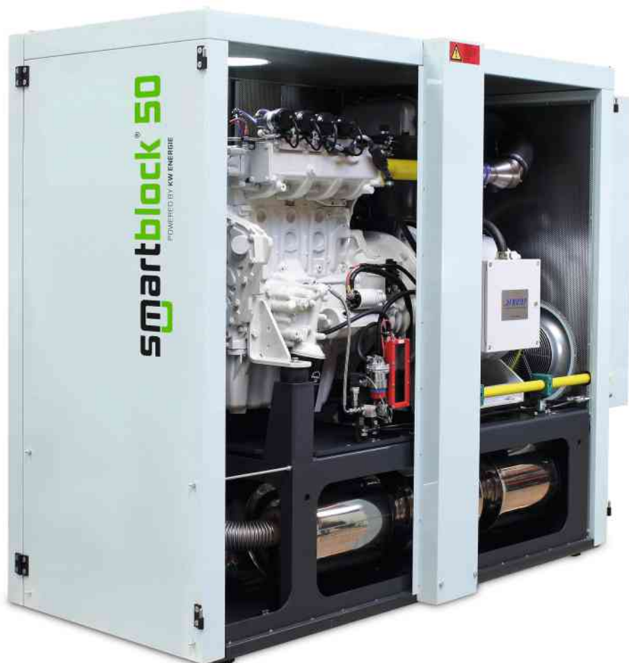
Mini-BHKW «smartblock 50» mit patentiertem Gasmotor. Elektrische Leistung 50 kW el , L x B x H = 290 x 104 x 171 cm, Gewicht 2400 kg.
