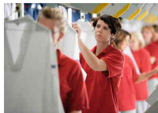
Regelmässige Kontrollen der Kleidungsstücke auf Verschleiss, Beschädigungen oder Restverschmutzungen gehören zur Hygieneanforderung der DIN 10524 oder DIN EN 14065.
